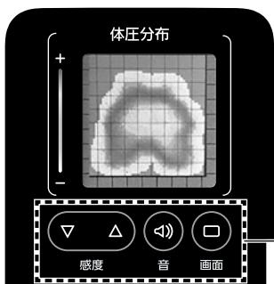
マットレスに利用者様が乗ると、床ずれ好発部位(仙骨・尾骨・大転子・腸骨)である臀部周辺の体圧データが計測され、色に置き換えてリモコン部の体圧分布モニターに表示されます。
