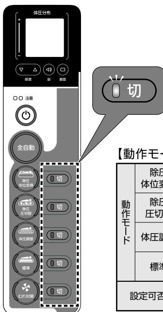
①使わない(止めたい)動作モードを手動で選択することにより、身体状況に応じた動作モードでマットレスを使用することができます。
