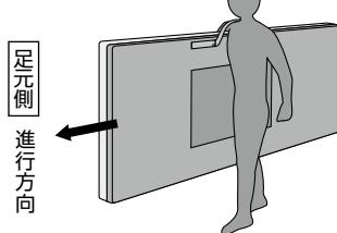
取っ手の真ん中の輪の部分に腕を通して運搬します。
