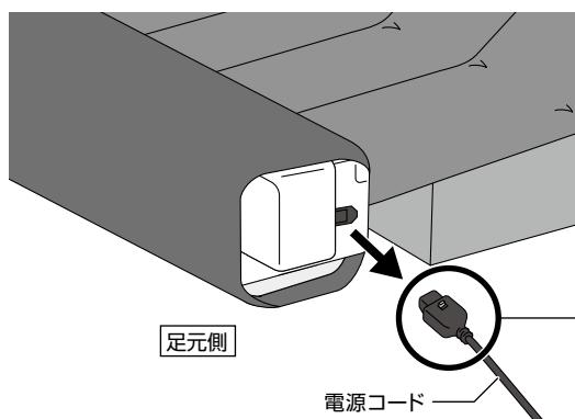
交換等で電源コードを取り外す場合は、ロックレバーを引きながら電源コードをエアポンプから抜いてください。
