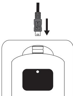
①充電スタンドにACアダプターの接続口を差し込み、コンセントに接続します。
