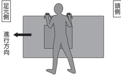
取っ手の外側の輪の部分を持って運搬します。
