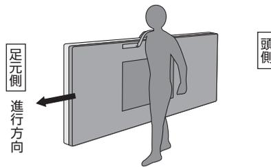
取っ手の真ん中の輪の部分に腕を通して運搬します。
