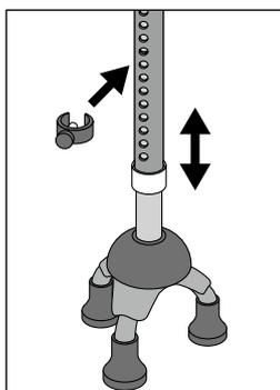
③高さ調整用固定穴を好みの位置に合わせ、ロックピンを取り付けます。ロックピンは奥までしっかりと入れてください。
