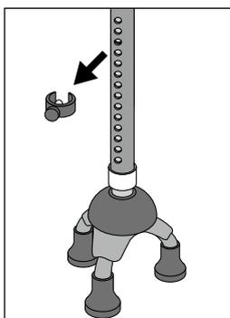
②高さ調整用ロックピンを外し、高さを調整します。
