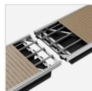
浮桟橋基本構造はフレーム、デッキ、フロートから構成されるセパレート構造を採用し、最小単位での補修・交換が可能な構造となっています。
