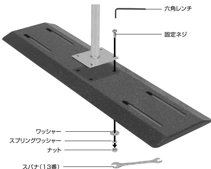
ナット・スプリングワッシャー・ワッシャー・固定ネジを左記の順番通りにしめ付け、ベースプレートとベースジョイントを取り付けます。
