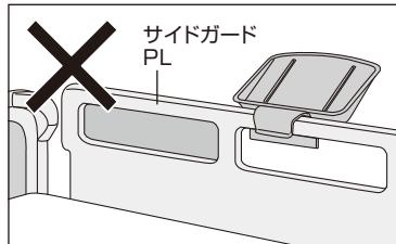
ウイングガードに取り付ける場合は、必ずベースバーに取り付け、手すり部分は避けてください。手すり部分に取り付けると、手すりを握りづらくなったり、トレイが不安定になり、重いものを乗せると外れる恐れがあります。
