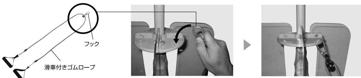
滑車に付いているフックを、伸縮パイプ側のディスクプレートに取付けます。
