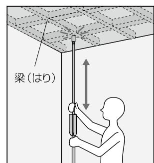
十字ストッパーがついていない状態の手すりで天井の数箇所を軽く突き、梁の有無を確認します。
