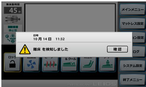
見守りしている状態を検知するとリモコンの表示とアラーム音でお知らせします。リモコンには左記のようなアラートが表示されます。
