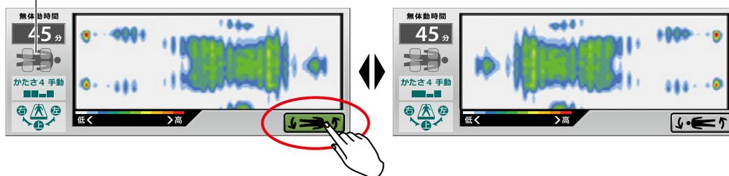
マットレスに患者様が乗ると体圧データが計測され色に置き換えてモニターに表示されます。
