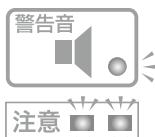
マットとポンプの異常をLEDランプの点滅と警告音でお知らせします。(P22参照)
