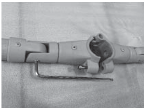
⑤ボルトナットをM5六角レンチでしめます。 ※手すりをはねあげられる硬さにしめます。 以上で④固定側の調整は完了です。
