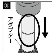
⑤ 手すりを下げ、高さ調整ストッパーが完全にアダプターに入っているか確認します。
