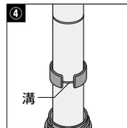
④ 溝に高さ調整ストッパーが固定されているか確認します。
